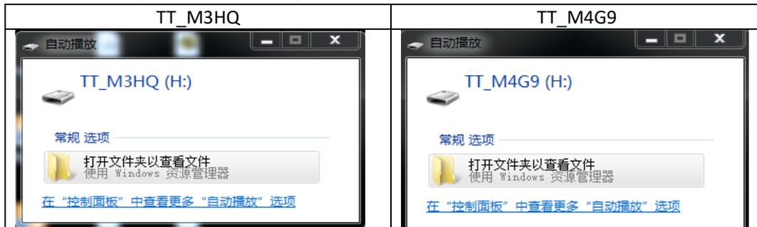
然后将 Step2 中编译的.bin 文件拖拽（或者拷贝）到对应的盘符中，拖拽（拷贝）完成后，按下 reset 键，会有如下输出。
