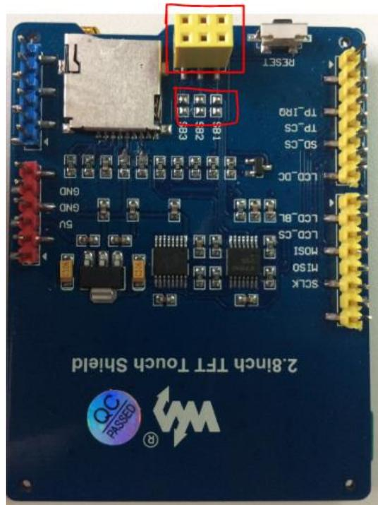
需要把图中的画红框的黄色底座摘除，然后将红框中 SB1、SB2、SB3 用 0 欧姆电阻连接起来。最终修改完成的之后如下图所示：
