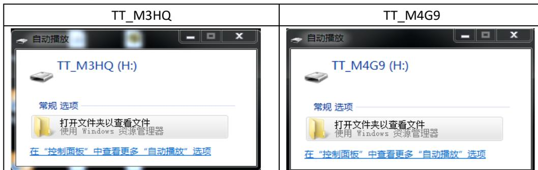
然后将 Step3 中编译的.bin 文件拖拽（或者拷贝）到对应的盘符中，拖拽（拷贝）完成后，按下 reset 键，会有如下输出。
