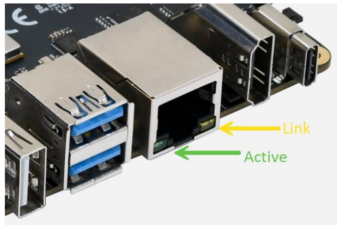
图3-2. Link & Active 指示灯
